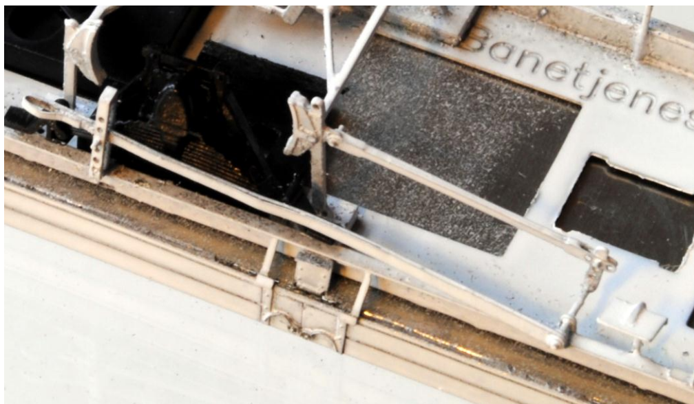
Figur 31. TDB med håndbremses placering. Bemærk at den ved TDB er vendt i ft. TD-vognen.
