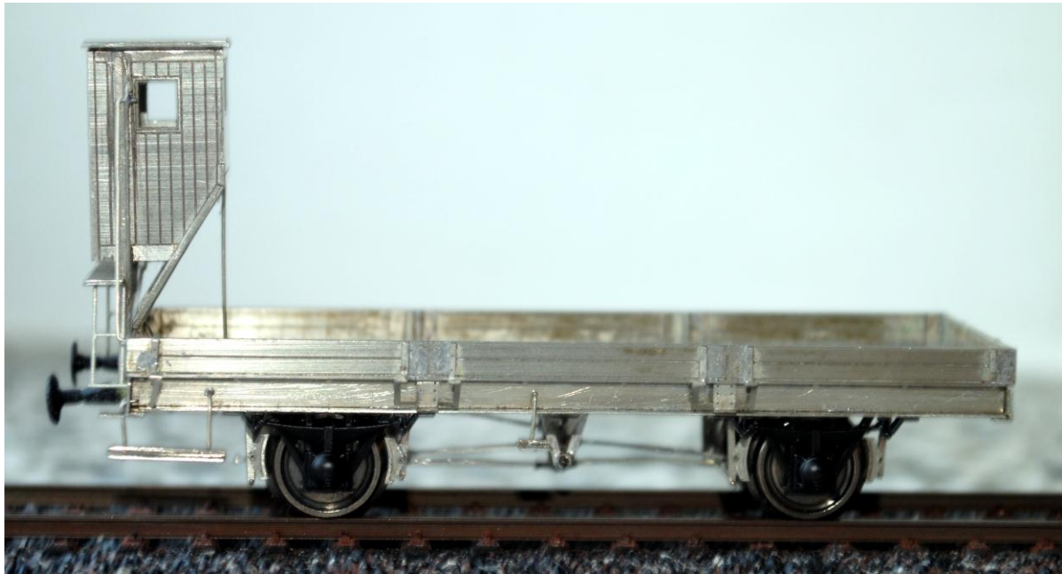
Figur 27. Vogn med bremsehus set fra siden.
